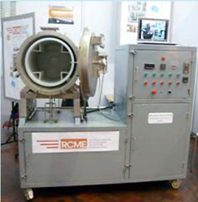
งานวิจัยและพัฒนาระบบอบแห้งอเนกประสงค์เชิงพาณิชย์โดยใช้ไมโครเวฟร่วมระบบสุญญากาศ (ยื่นจดสิทธิบัตรแล้ว)
