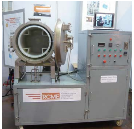
งานวิจัยและพัฒนาระบบอบแห้งเนกประสงค์เชิงพาณิชย์โดยใช้ไมโครเวฟร่วมกับระบบสุญญากาศ
