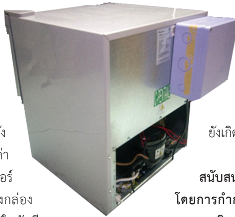
ชุดกล่องควบคุมการโตของเห็ด ติดตั้งบริเวณหลังตู้เย็น
